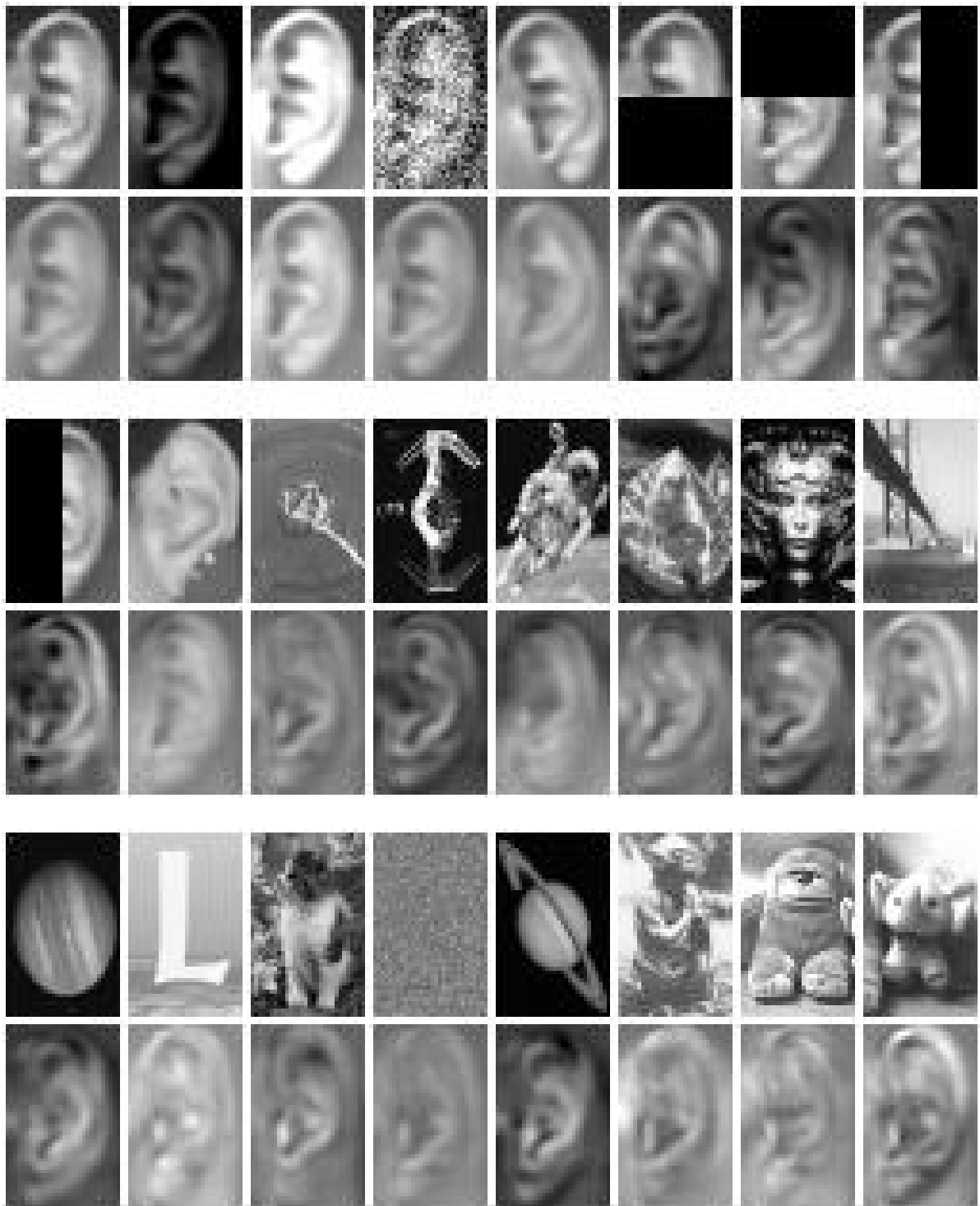
Figura 18: Imágenes de entrada y su reconstrucción por la red de compresión.
